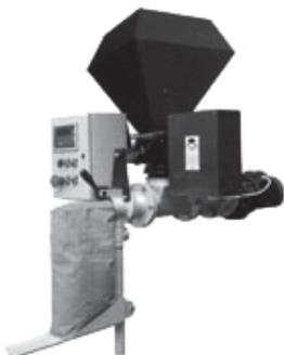
*Предназначен для автоматического взвешивания, дозирования и фасовки в клапанные мешки любых сыпучих материалов, таких как строительные смеси, минеральные вещества и др.*
