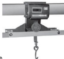
**ОПИСАНИЕ:** весы встраиваются в участок штатного монорельсового пути любой формы. При движении груза по монорельсу на участке весов проводится взвешивание с выводом результата на весовой индикатор. Индикатор весов может быть расположен непосредствен-
